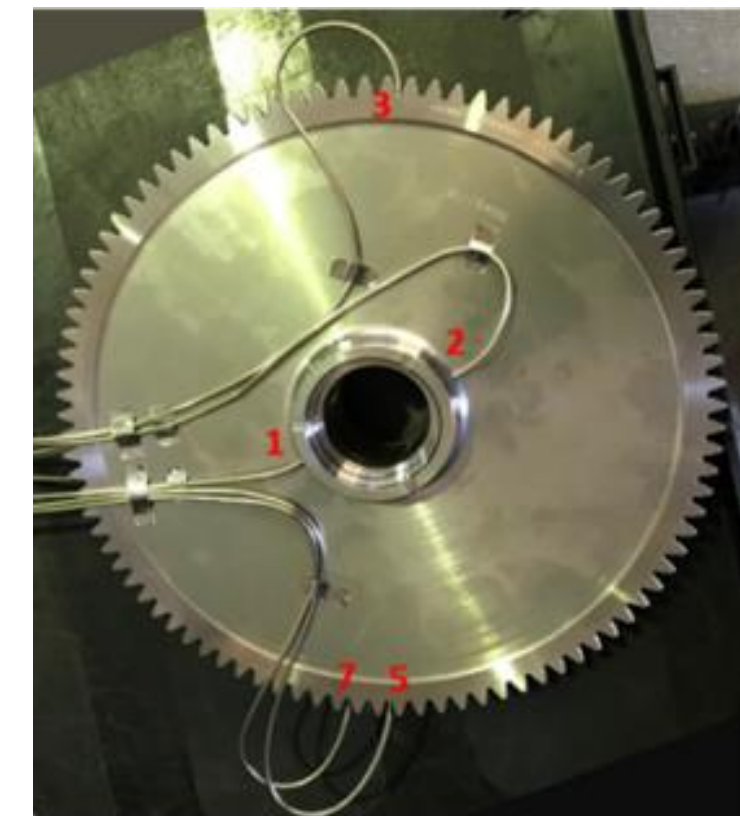
Instrumentation avec Thermocouple pour identifier les conditions aux limites thermiques
